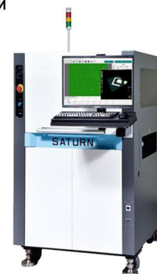
Линейная система АОИ 3D паяльной пасты
